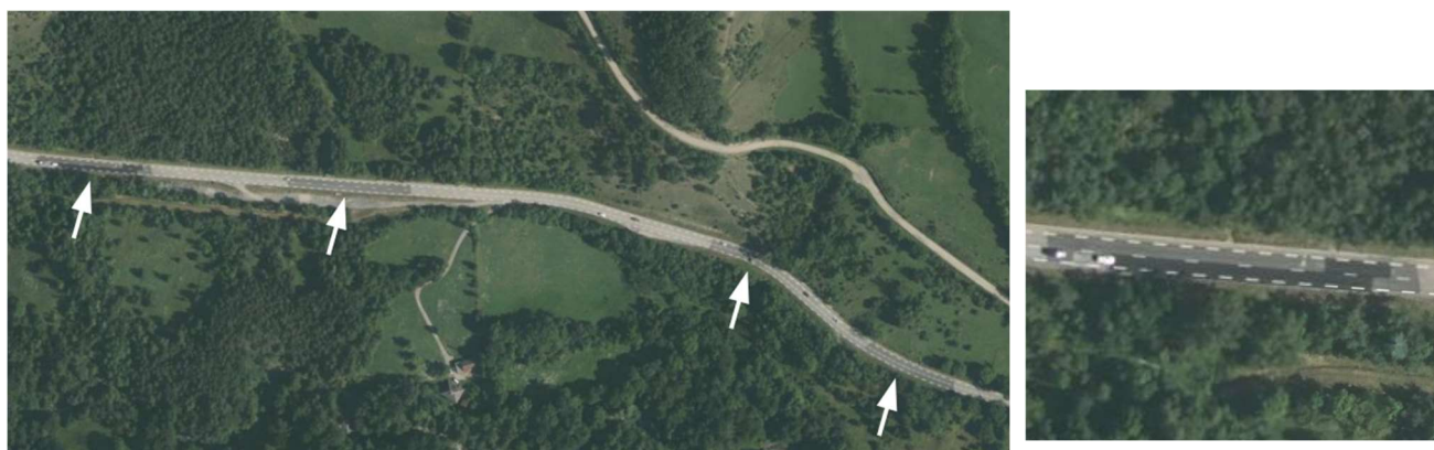
Figure 15 : Photographies aériennes 2021 (source Geoportail) : (à gauche) reprises de chaussée visibles en plusieurs endroits de la zone d'étude ; (à droite) reprises successives sur la partie la plus active de la zone 1.
