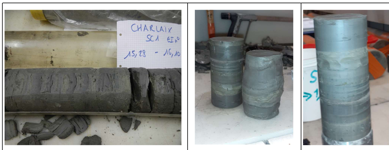
Figure 5 : Litages bien visibles sur des échantillons issus des prélèvements carottés du site de Charlaix.
