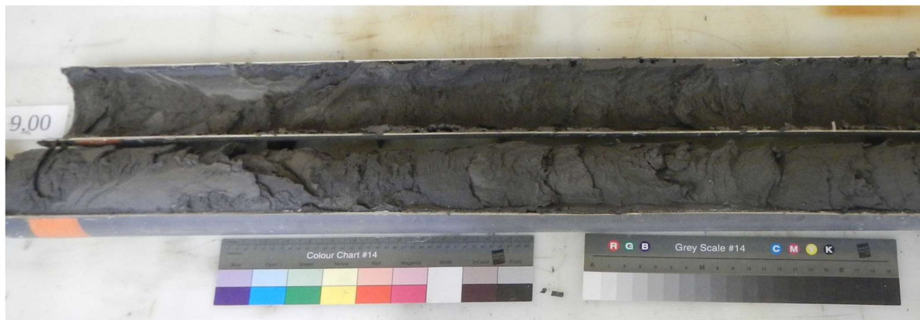
Figure 3 : Prélèvement fortement altéré à l'ouverture de la carotte par adhérence sur la gaine (sondage S8-SC2 de 9.00 à 10.50 m, Les Touches). Échantillons non retenus pour des essais mécaniques.
